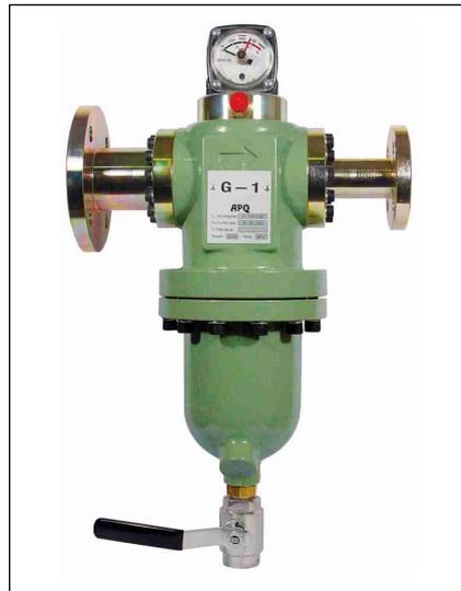
Viene dotado de un grupo de válvula manifold y manómetro diferencial auto conectado bi-direccional lo que permite eliminar los tubings de conexión al manómetro. El manifold dispone de una válvula de intercomunicación de la presión de entrada y salida para la verificación del manómetro diferencial. La aplicación típica es en las estaciones de regulación y medida de alta presión o en aquellas que se desee una pérdida de carga en el filtro muy baja.
